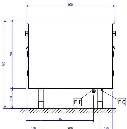
EI = Conexión eléctrica (energía)
